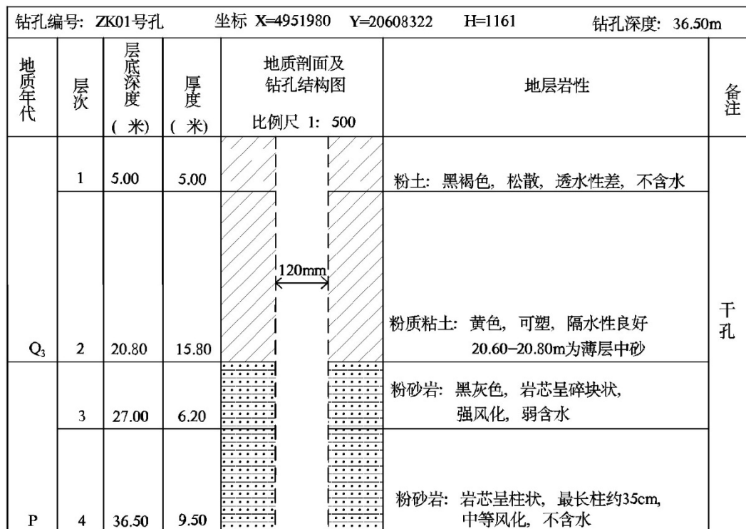
图 5.2.3-5 ZK01 钻孔柱状图
