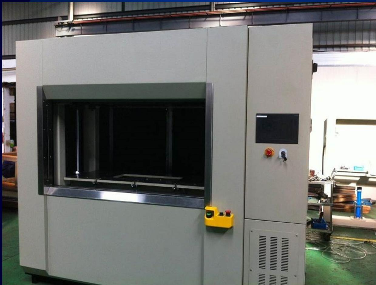
VW700线性振动摩擦焊接机
