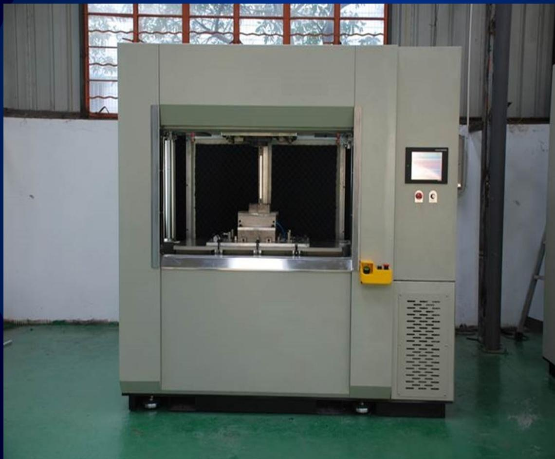
VW500线性振动摩擦焊接机
