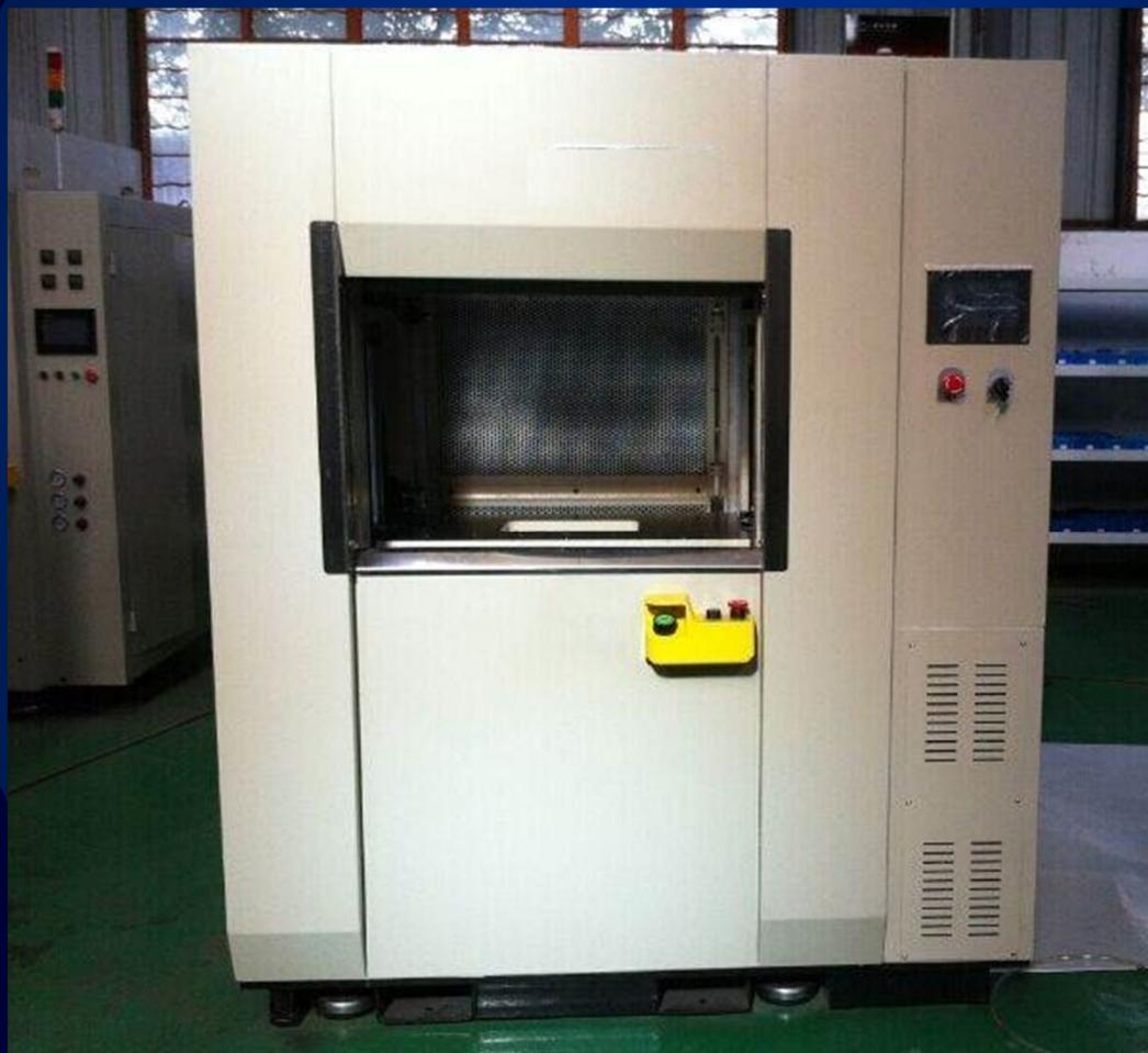
VW150线性振动摩擦焊接机
