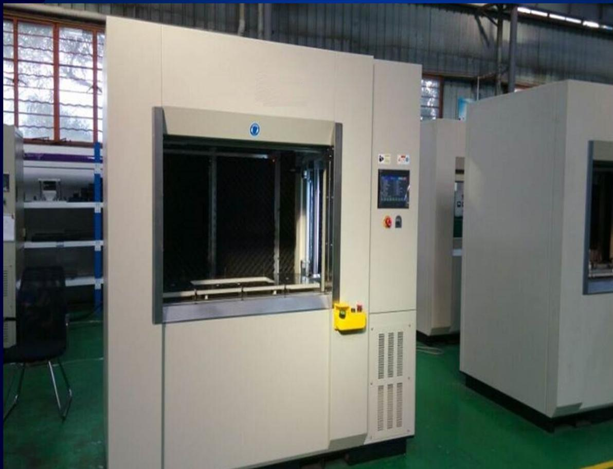
VW350线性振动摩擦焊接机
