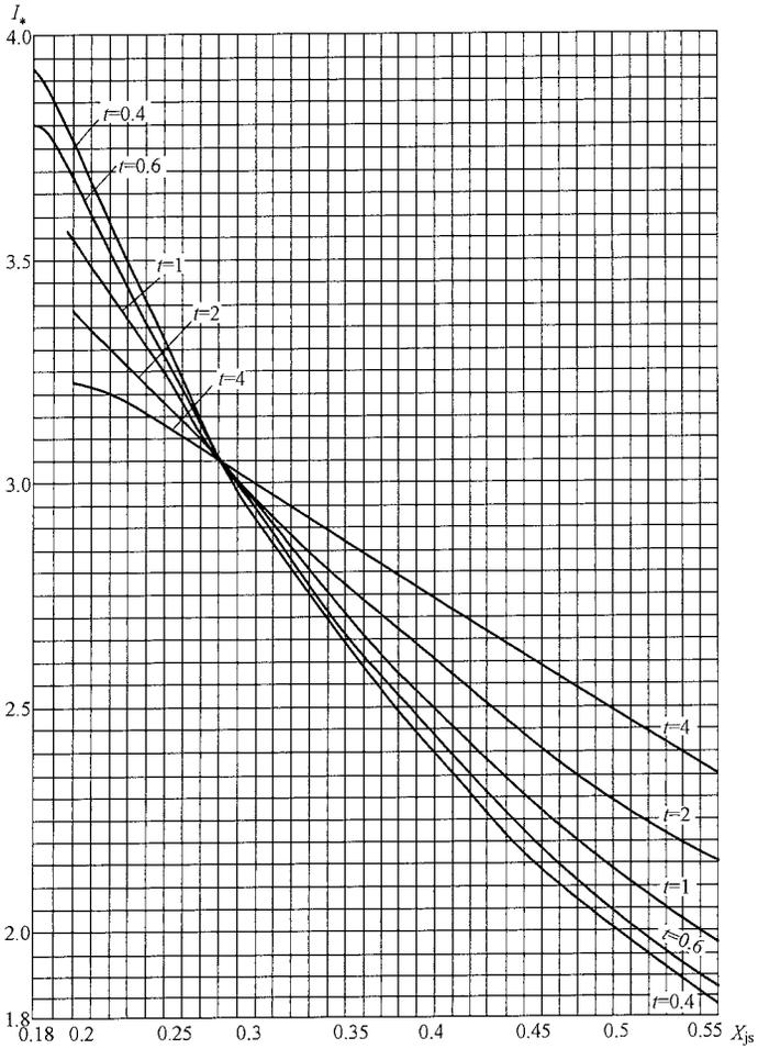
图 F.7 水轮发电机运算曲线 (二) ( $X_{js}=0.18\sim 0.56$ )
