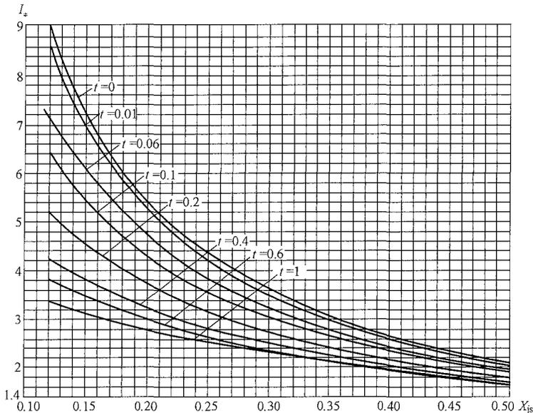
图 F.1 汽轮发电机运算曲线（一）（ $X_{js}=0.12\sim 0.50$ ）
