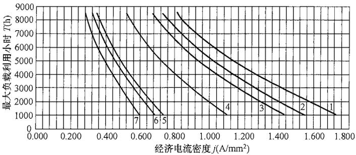
1—矩形铜母线; 2—共箱铜母线; 3—封闭母线; 4—铝锰合金管形母线;
