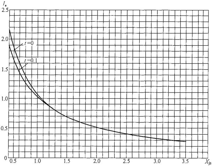
图 F.8 水轮发电机运算曲线 (三) ( $X_{js}=0.50\sim 3.50$ )
