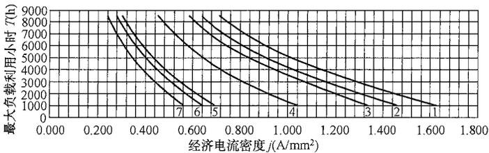
1—矩形铜母线; 2—共箱铜母线; 3—封闭母线; 4—铝锰合金管形母线;
