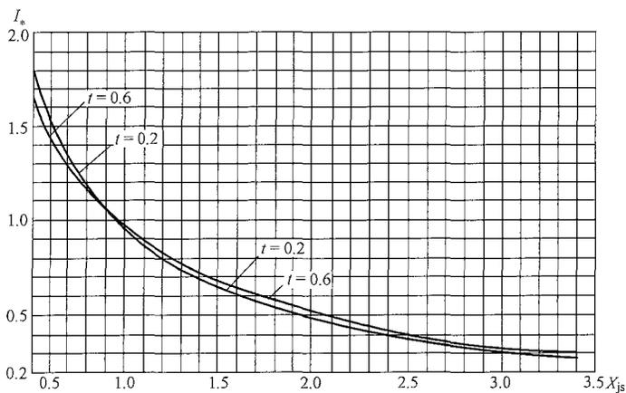
图 F.4 汽轮发电机运算曲线 (四) ( $X_{js}=0.50\sim 3.45$ )
