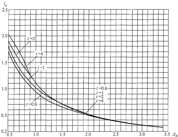
图 F.5 汽轮发电机运算曲线 (五) ( $X_{js}=0.50\sim 3.45$ )
