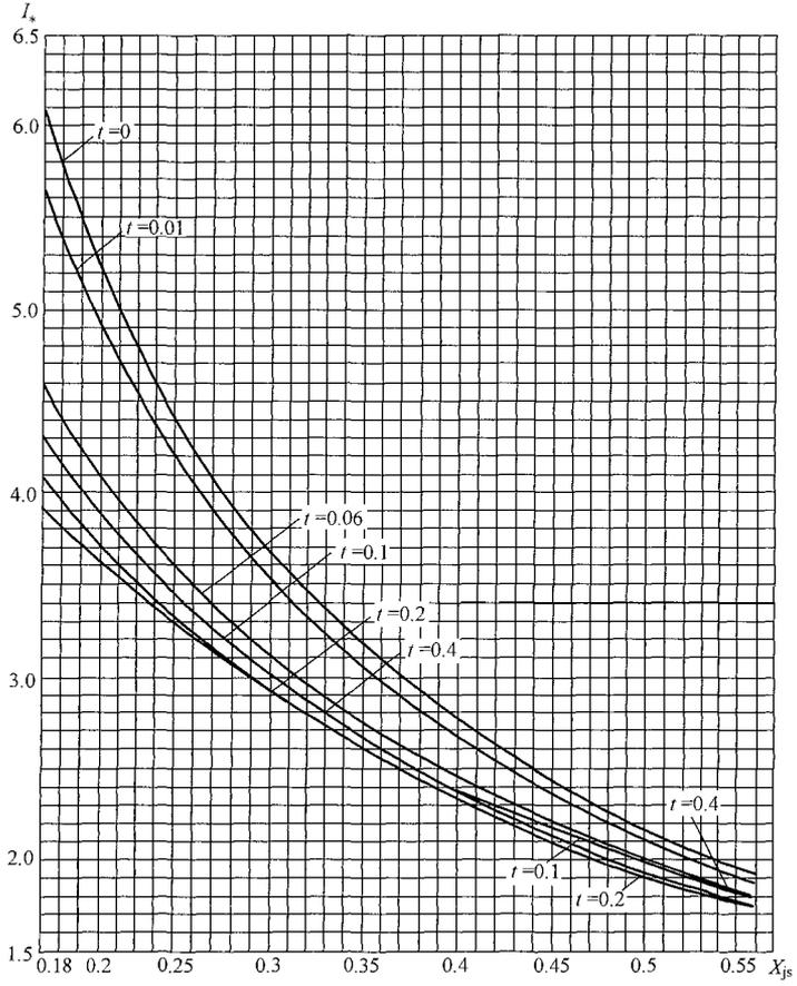
图 F.6 水轮发电机运算曲线 (一) ( $X_{js}=0.18\sim 0.56$ )
