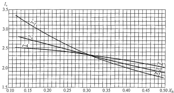
图 F.2 汽轮发电机运算曲线 (二) ( $X_{js}=0.12\sim 0.50$ )
