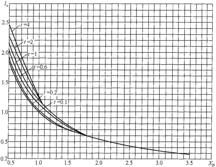
图 F.9 水轮发电机运算曲线 (四) ( $X_{js}=0.50\sim 3.50$ )
