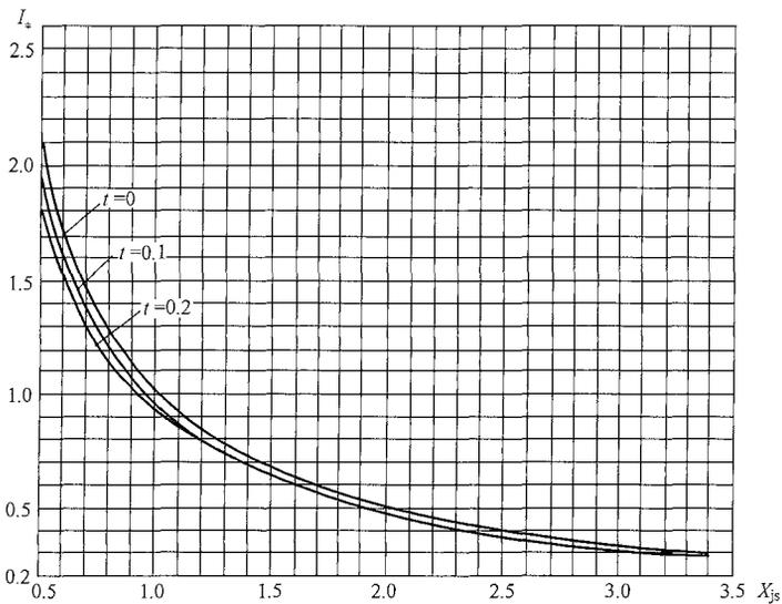
图 F.3 汽轮发电机运算曲线 (三) ( $X_{js}=0.50\sim 3.45$ )
