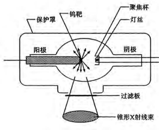
图 9-1 X 射线管示意图
