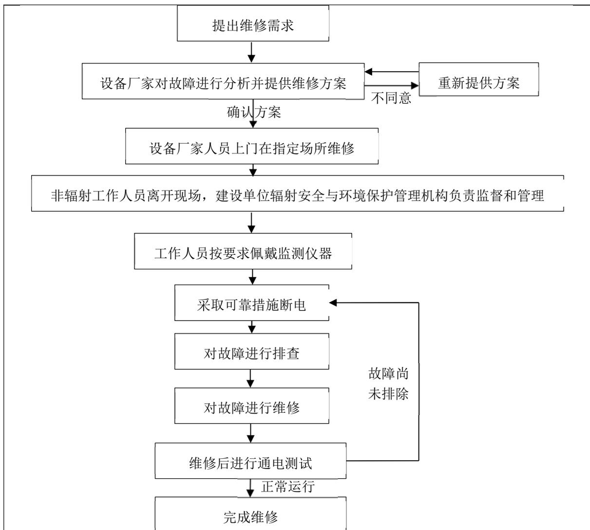
图 10-8 设备维修流程图
