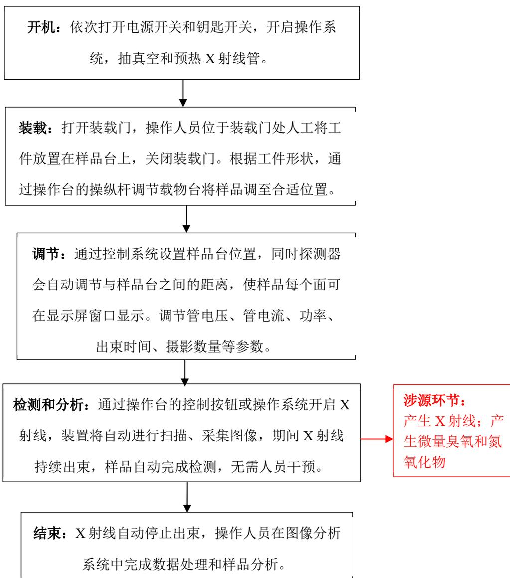
图 9-4 工艺流程和产污环节图
