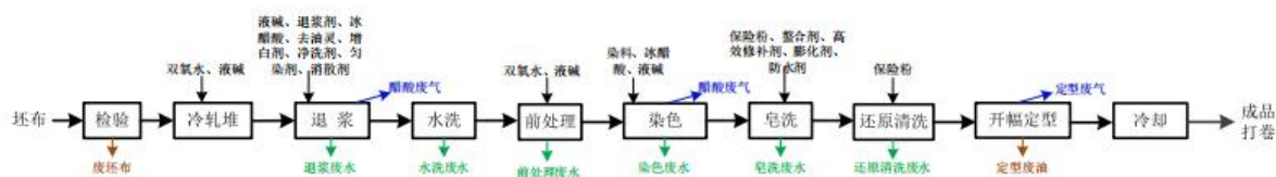
图 3-8 高摩擦水洗桌布生产工艺流程图
