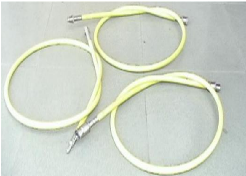
图 9-5 \gamma 射线探伤机输源管示意图
