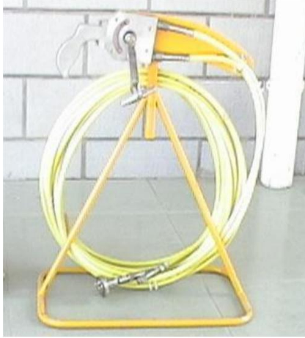
图 9-4 \gamma 射线探伤机控制部件
