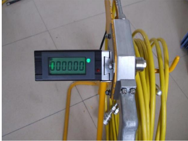
图 9-6 \gamma 射线探伤机源辨位置指示系统
