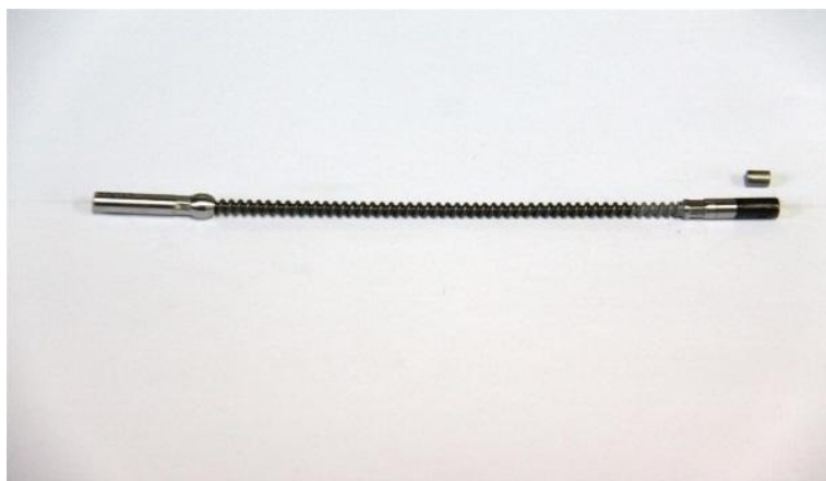
图 9-7 S 通道 ^{192}\text{Ir} 源辨示意图
