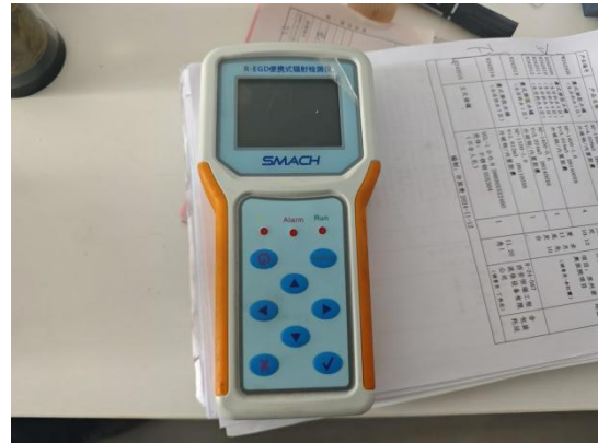
图 3-19 便携式 X-γ剂量率仪
