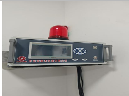
图3-9 固定式辐射剂量监测仪
