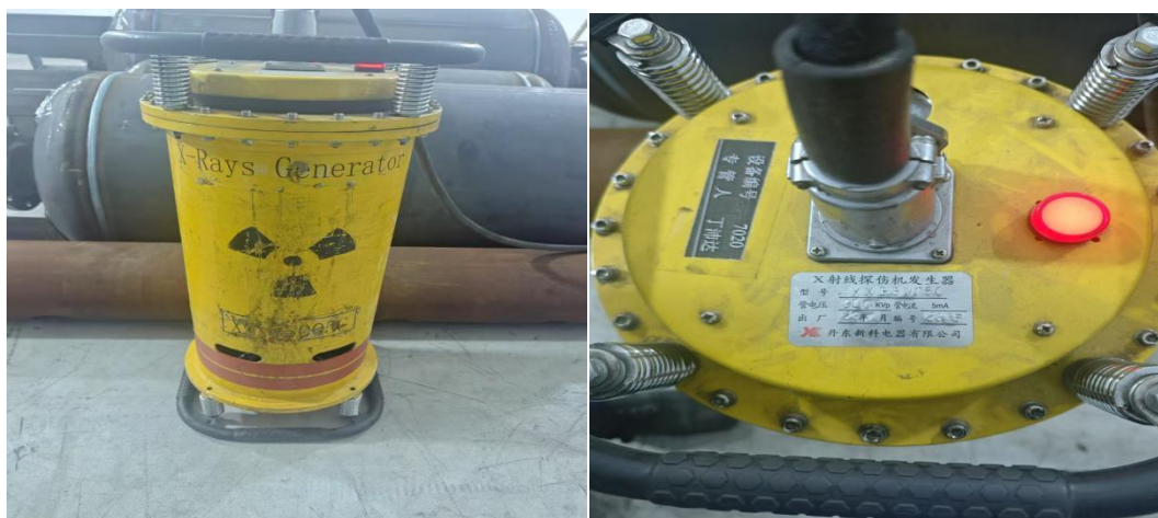
图 2-4 本项目 X 射线探伤机外观图示意图
