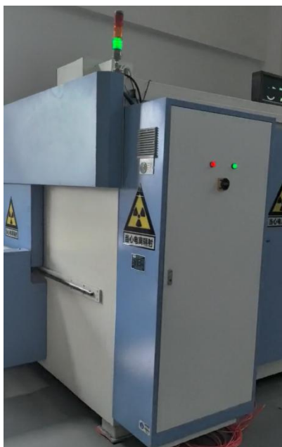
图 2-6 X 射线实时成像检测系统整体外观示意图
