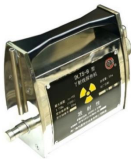
图 9-2 典型 ^{192}\text{Ir} - \gamma 射线探伤机外观图
