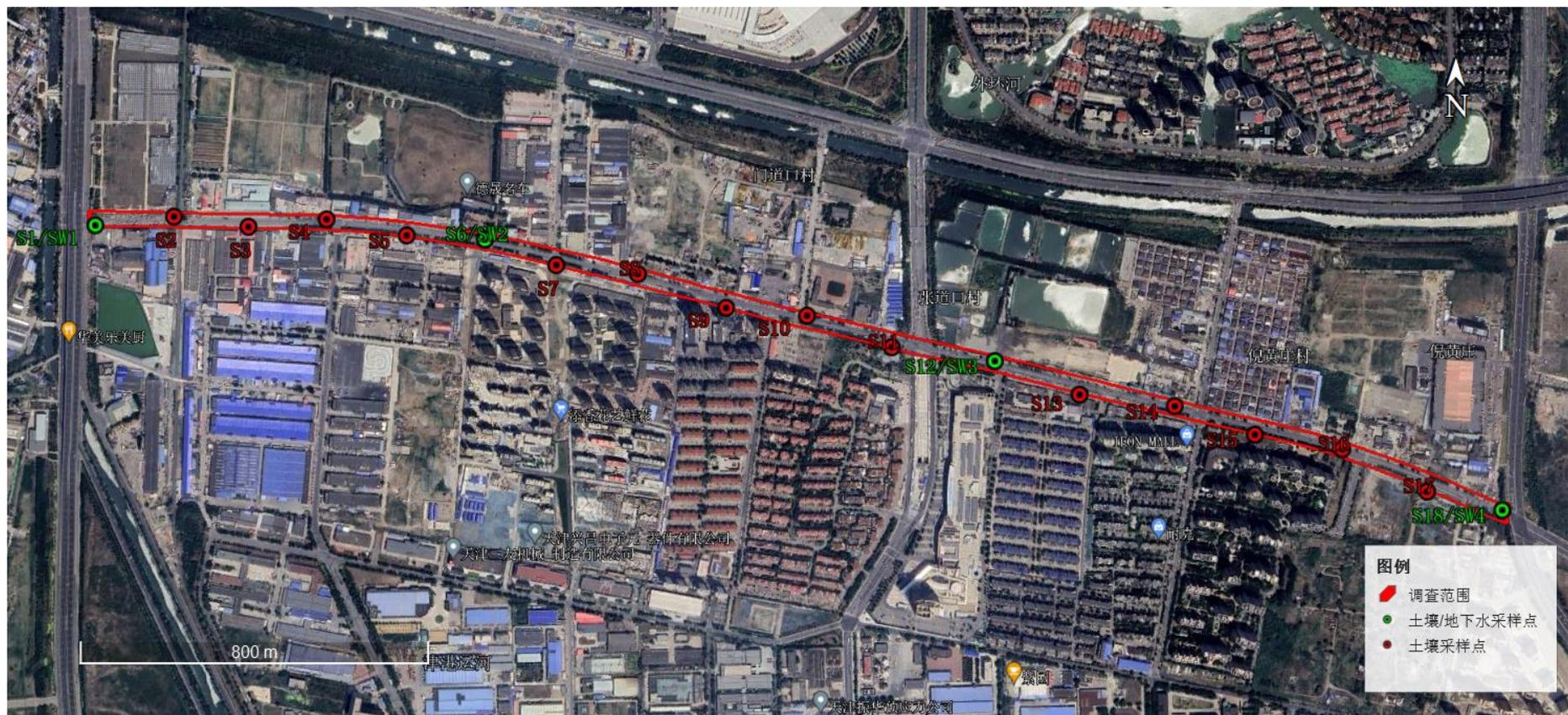
图 2-3 土壤/地下水取样点平面布置图
